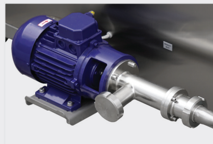
Csigaszivattyú a pasztörizálóra szerelve.
