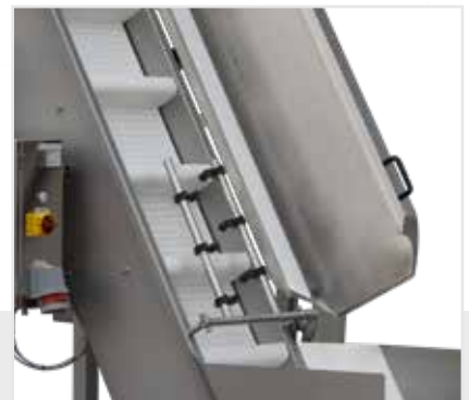
Fúvókák a gyümölcsök friss vízzel történő öblítéséhez.
