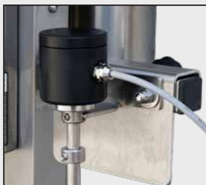
Opció: folyadékszint-kapcsoló az automatikus indítás és leállítás számára
