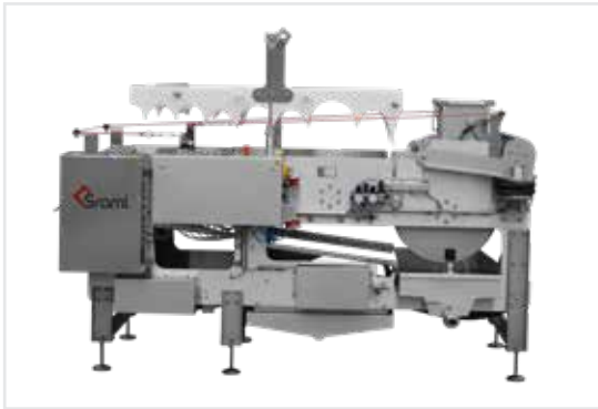
A pépvezetők felemelése tisztítás céljából
