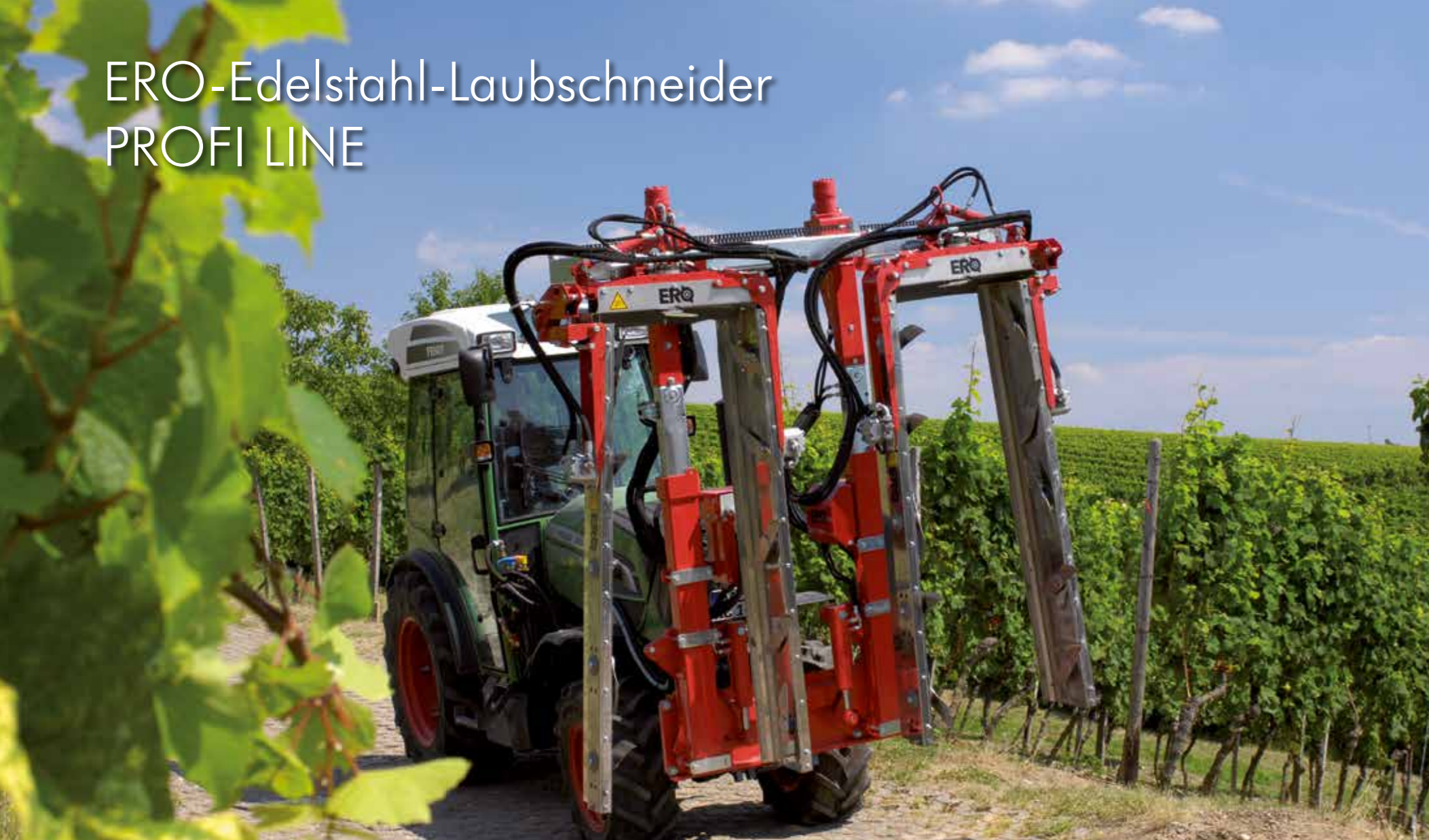
ERO-Laubschneider Modul Line einseitig ■ hydraulische Seitenneigung am Hubrahmen (Option)
