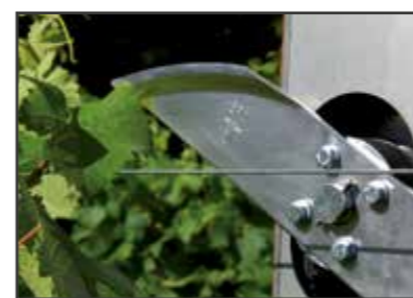
ERO-Edelstahl-Turbomeser (Grundausrüstung) ■ Drahtabweisende Messer verhindern das Aufwickeln und Durchtrennen der Drähte. ■ Speziell vergüteter Messerstahl verhindert das Ansetzen von Schnittresten auf der Schneide (Tefloneffekt). ■ Die Oberflächenqualität bleibt auch beim Nachschleifen erhalten (keine Beschichtung). ■ Die abgerundete Schneide bewirkt einen ziehenden, glatten Schnitt. ■ Aufgrund der Sogwirkung der Messer verbleiben keine Schnittreste in der Laubwand, auch kleine Triebspitzen und Blätter werden erfasst. ■ Die 35,5 cm langen Messer belasten die Lager nur wenig. Der Laubschneider kann nah am Traktor angebaut werden, wodurch sich ein kleinerer Wenderadius ergibt. Darüber hinaus wird die Gefahr einer Beschädigung der Traubenzone bei Lenkbewegungen oder Bodenunebenheiten minimiert. ■ Geprüft nach DIN EN 706.
