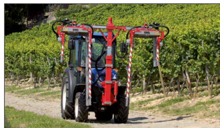
Spazierstock zweiseitig ■ hydraulische Breitenverstellung, 90 cm Verstellweg (Serie) ■ elektrische Seitenneigung am Schneidbalken (Option) ■ Schneidwerkverlängerung Überzeilenseite (Option)
